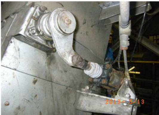
写真 11 エアシリンダ交換・復旧
