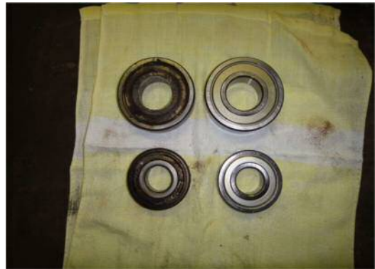
写真 14 ベヤリングの交換
