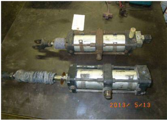
図 10 修繕済みのエアシリンダと交換
