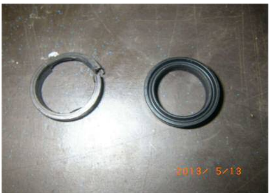
写真 12 エアー漏れしたパッキンの交換
