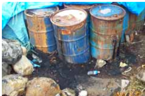
写-1 漏洩した一部の硫酸ピッチ
