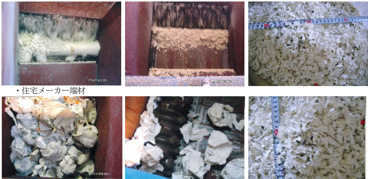
図 2 塩ビ壁紙廃材の破砕状況
