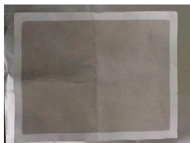
図-3 HV による石英繊維ろ紙の捕集状況
