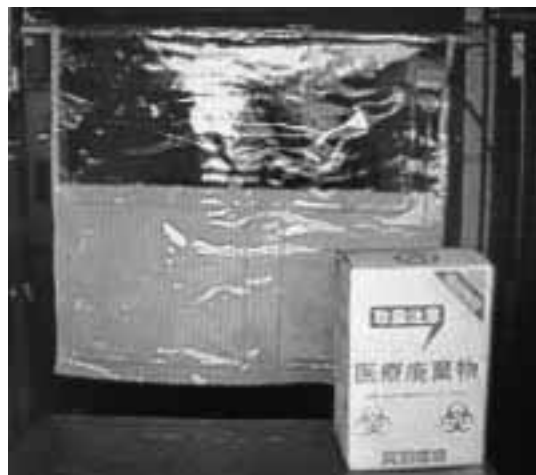
写真3：のれん型ゲートアンテナ
